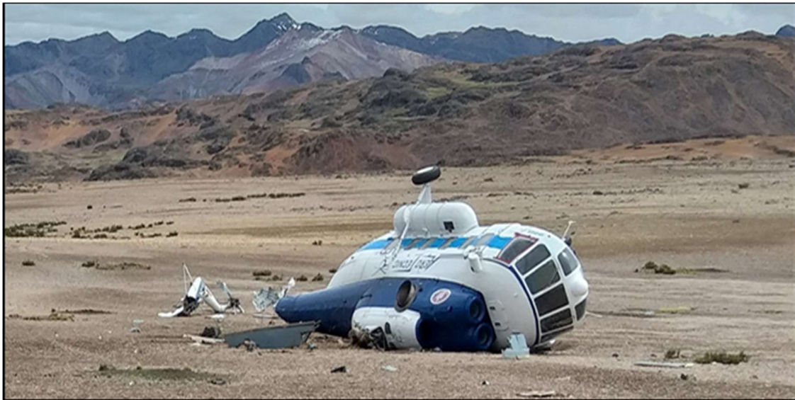
Posición final del helicóptero después del accidente, nótese la separación del empenaje con el rotor de cola y la ausencia de las palas principales
